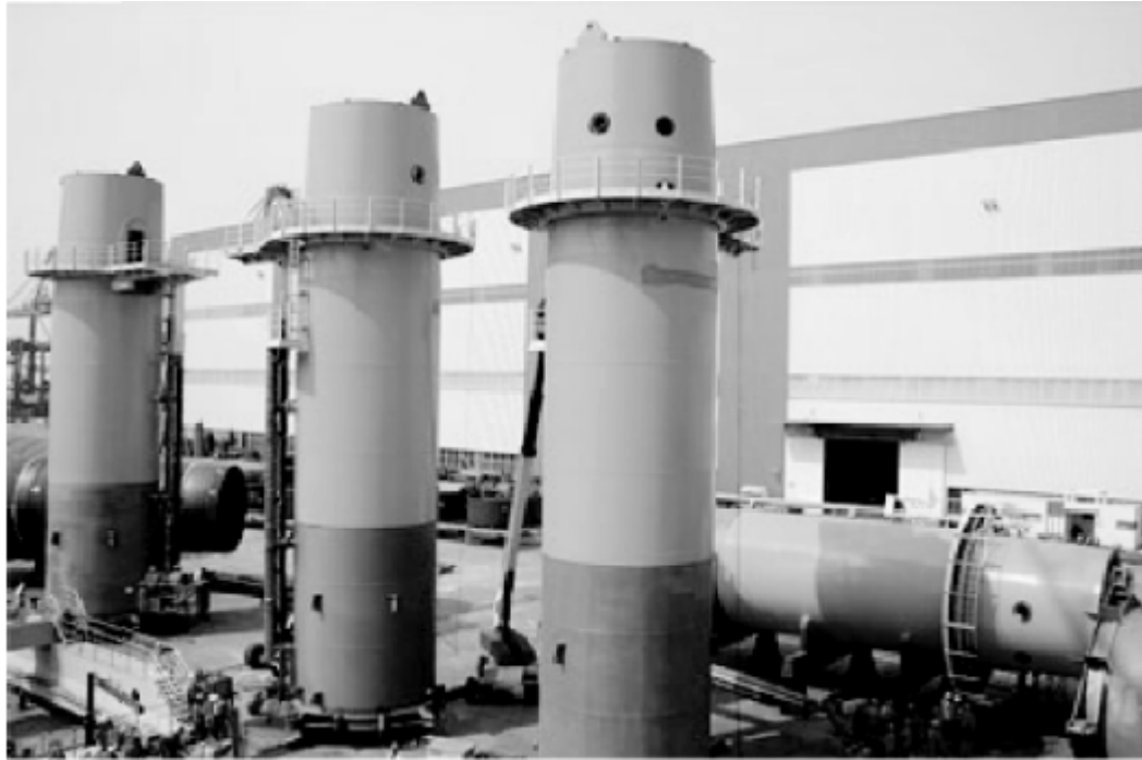
图2 风力发电管桩
